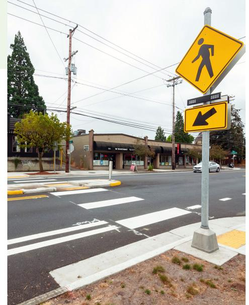
**Arriba:** Ejemplo de un cruce con balizas rectangulares de intermitencia rápida (RRFB) finalizado, que crea un cruce peatonal más seguro y visible a lo largo de un corredor muy transitado.
